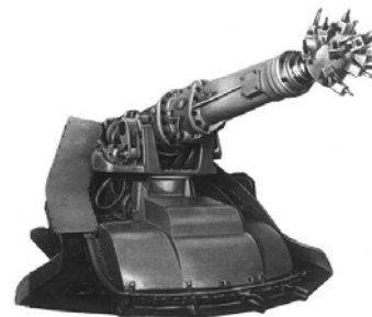
Рис. 7 Проходческий комбайн 4 ПУ
