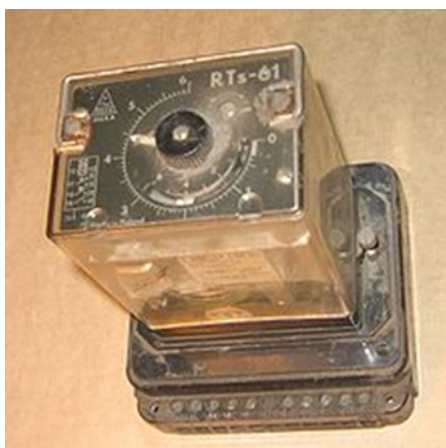
Рисунок 10 - Реле времени с часовым механизмом
