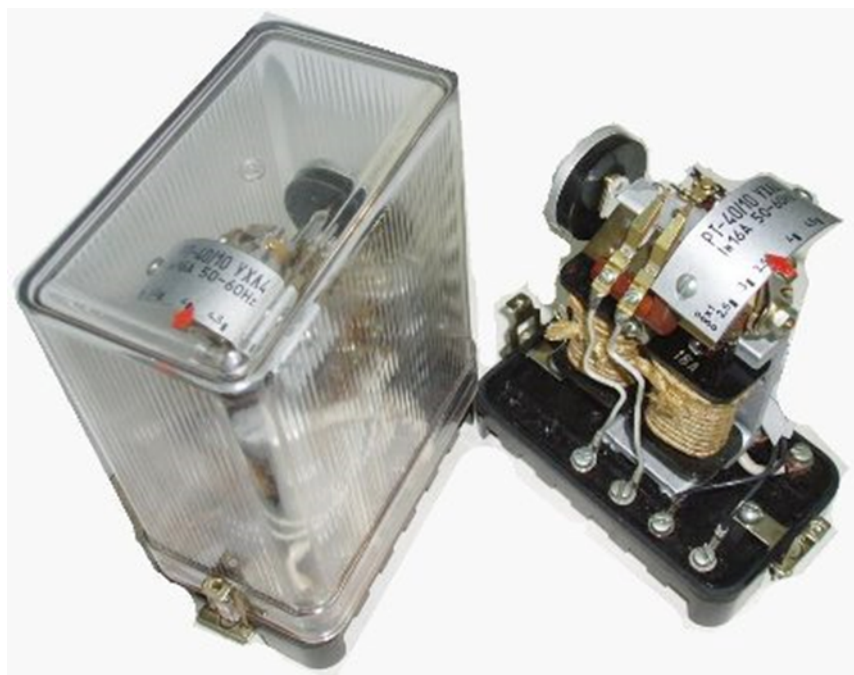
Рисунок 11 - Электромагнитное реле максимального тока серии РТ40
