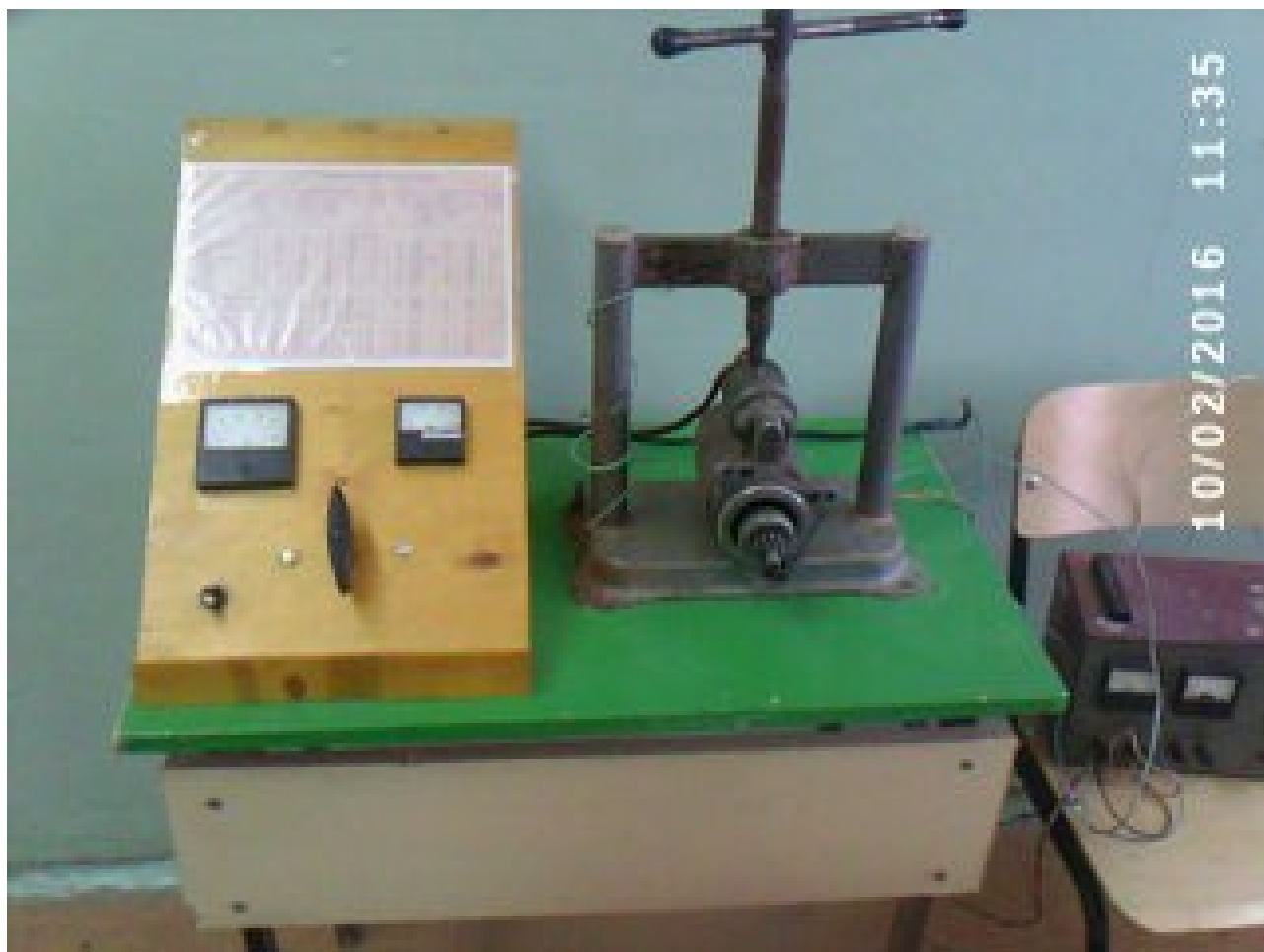
Рис. 6. Стенд для испытания стартера в режиме холостого хода.
